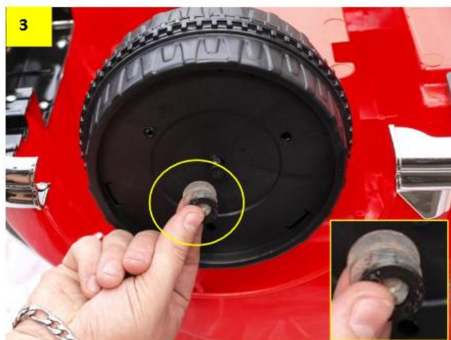
Obr. 5 a 6: Na přední osy nasadíte kovové podložky a připravíte si přední kola.
