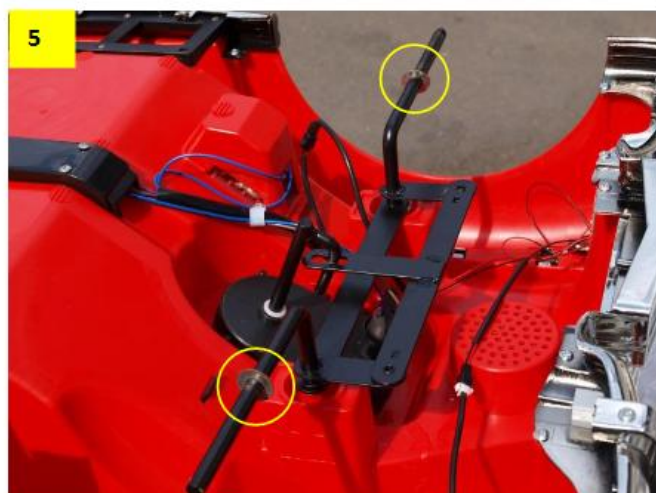
Obr. 5 a 6: Na přední osy nasadíte kovové podložky a připravíte si přední kola.
