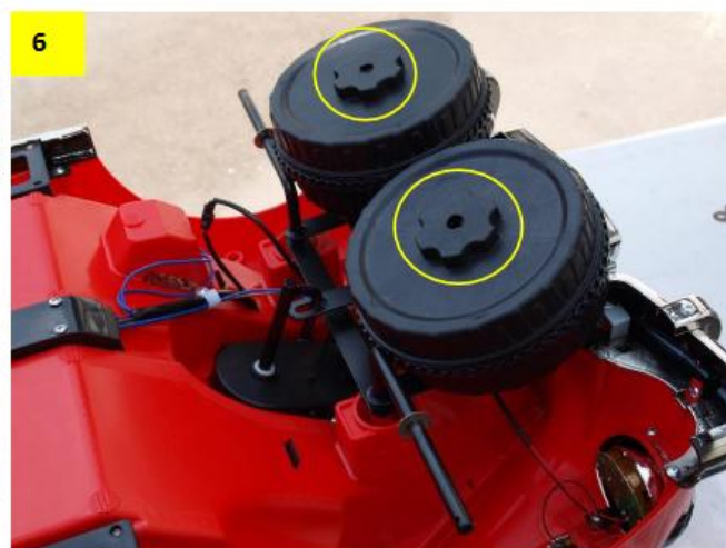
Obr. 5 a 6: Na přední osy nasadíte kovové podložky a připravíte si přední kola.
