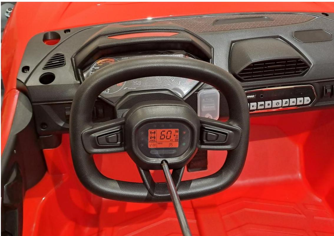
**Do volantu vložte dvě tužkové baterie ( nejsou součástí balení)**
