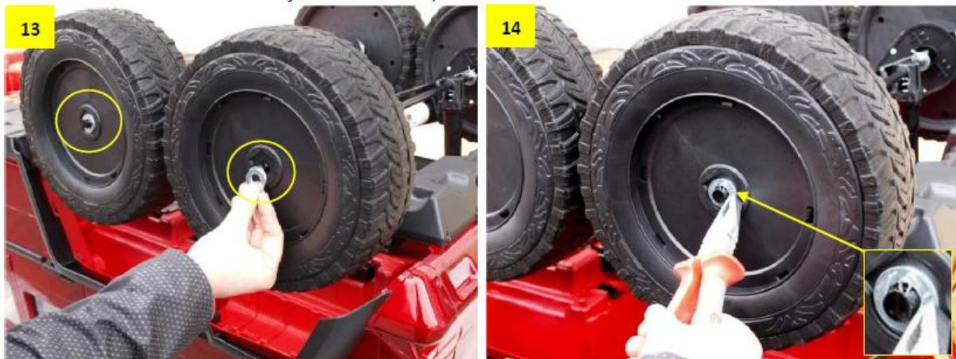
**Obr. 15:** Vyšroubujte všechn 6 šroubků vyznačených na obrázku a položte je prozatím stranou.
