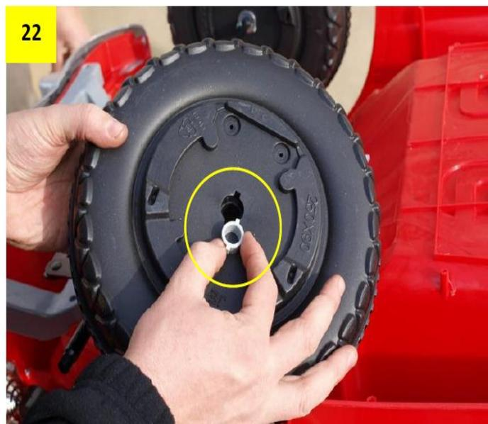
Obr. 23 a 24: Nasadte kola na osy a k oběma kolům přiložte jednu kovovou podložku.
