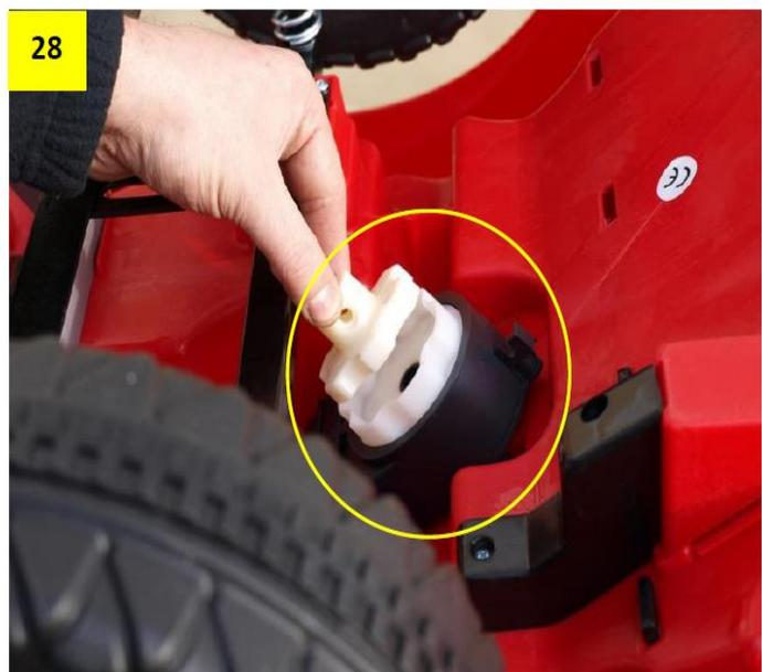
Obr. 29 a 30: Osu řízení namažte vazelínou/olejem a umístěte ji dle obrázku.
