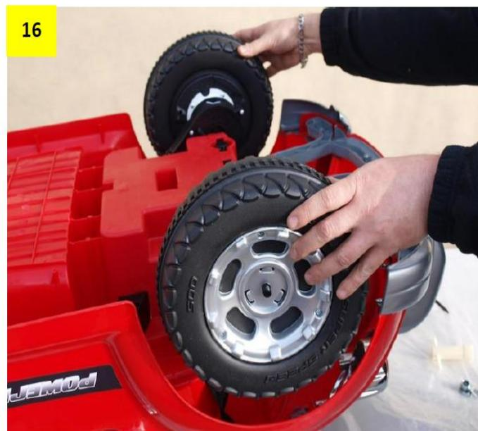
**Obr. 17 a 18:** K oběma kolům nyní přiložte 2 kovové podložky a následně na osu našroubujte matice, které utáhněte. Během utahování matic si osu přidržte kleštěmi jako na obrázku.
