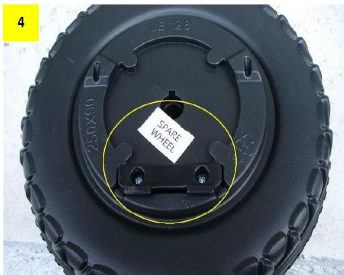
Obr. 5-7: Rezervní kolo nyní nasadíte a přišroubujete na víko kufru auta.
