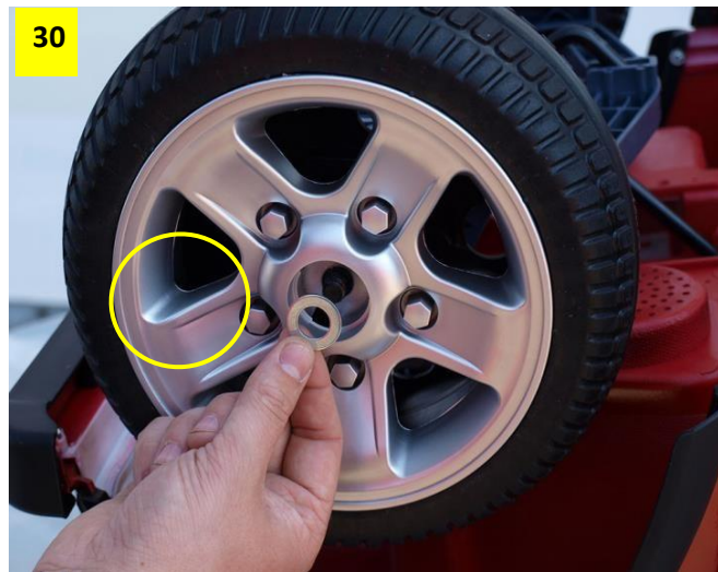
Obr. 29: Obě přední kola nasadte na osy. Obr. 30: Stejně jako u zadních kol, nasadte k oběma předním kolům kovové podložky a kovové matice.
