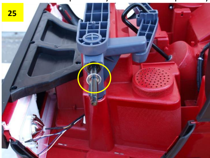
Obr. 27: Namažte přední osy vazelínou nebo olejem. Obr. 28: Přední kola
