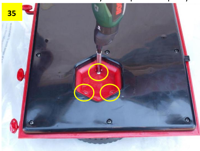
Obr. 36: Označené šroubky mírně povolte – panty se poté budou lépe otvírat.
