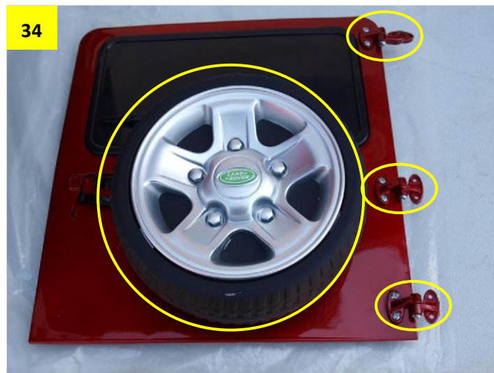
Obr. 36: Označené šroubky mírně povolte – panty se poté budou lépe otvírat.
