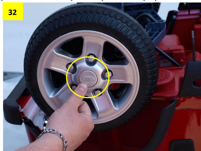
Obr. 31 a 32: Nasadte kovové matice, které utáhněte. Jako poslední následně přiložte plastové krytky.
