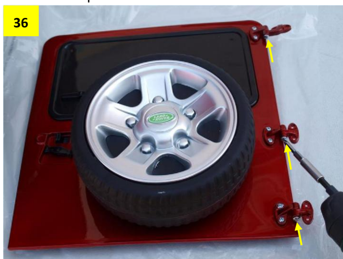
Obr. 36: Označené šroubky mírně povolte – panty se poté budou lépe otvírat.
