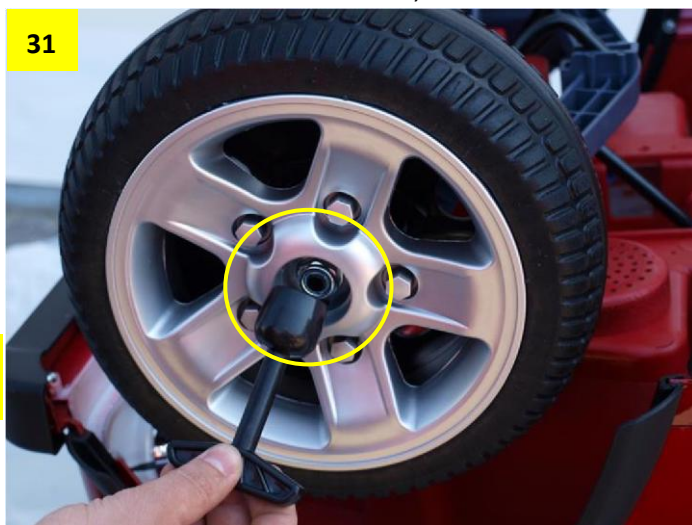
Obr. 31 a 32: Nasadte kovové matice, které utáhněte. Jako poslední následně přiložte plastové krytky.
