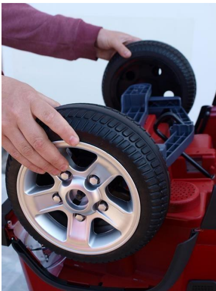
Obr. 29: Obě přední kola nasadte na osy. Obr. 30: Stejně jako u zadních kol, nasadte k oběma předním kolům kovové podložky a kovové matice.
