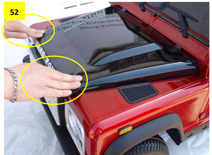
Obr. 53: Přišroubování kapoty zespod autíčka. Obr. 54: Před stažením ochranné folie logo Land Rover uhladte a zatlačte prstem. Folii stáhněte opatrně a pomalu.
