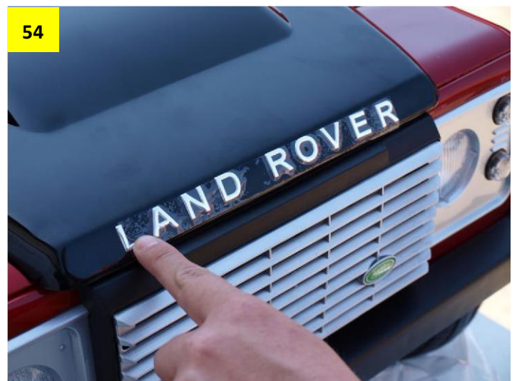
Obr. 53: Přišroubování kapoty zespod autíčka. Obr. 54: Před stažením ochranné folie logo Land Rover uhladte a zatlačte prstem. Folii stáhněte opatrně a pomalu.
