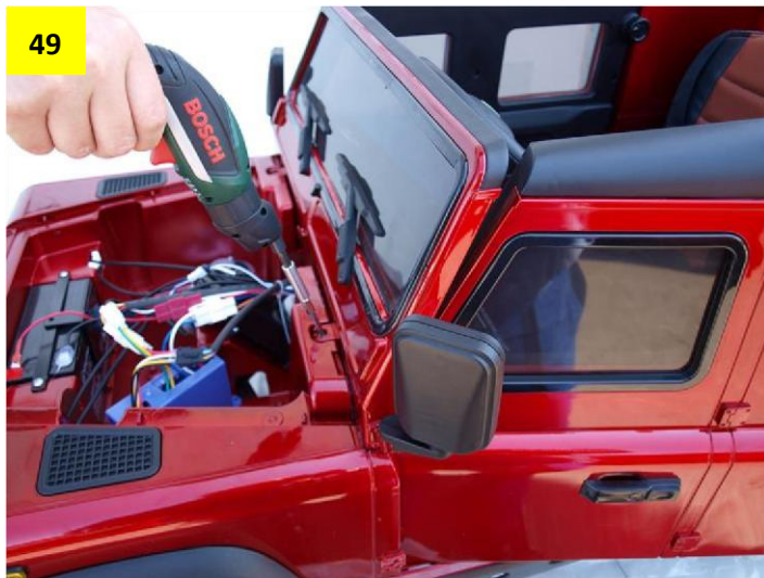
Obr. 49: Přední okno přišroubujte.
