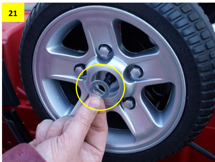
Obr. 23 a 24: Jako poslední na kola nasadíte plastové krytky.
