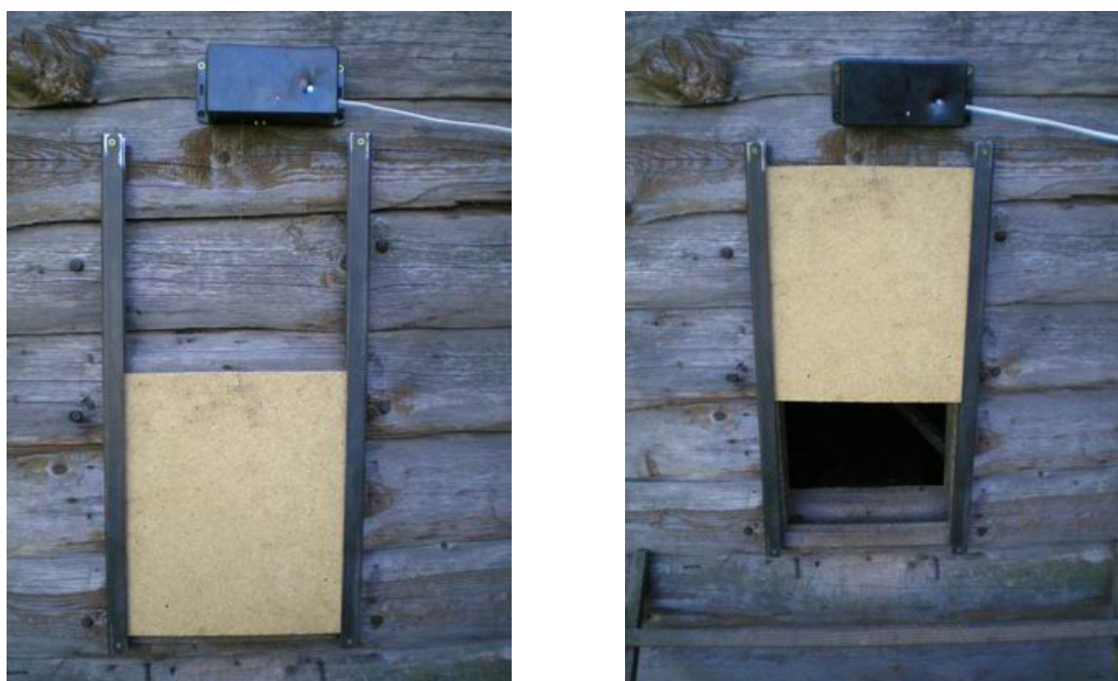
Obr. 3. Montáž dvířek vruty do dřeva, zavřená, otevřená dvířka.
